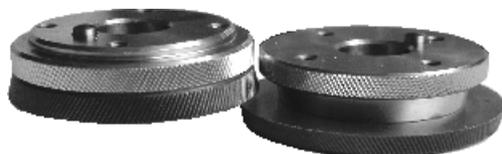
Galets de découpe K9-AR, indispensables pour le démontage efficace de profils anciens ou détériorés par une tempête (Découpe le joint à une vitesse de 9m/min.). La structure porteuse ne sera pas abîmée.
