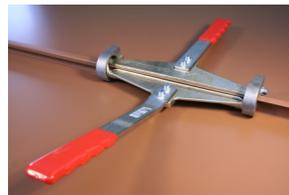
Abb. K8 Schließhebel komplett nach unten gedrückt
