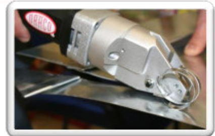
Schneiden über umgelegten Doppelfalz im Dachbereich 6-fach-Falz!!
