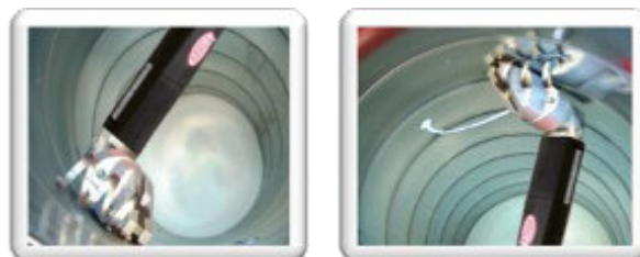
Die geringe Bautiefe der 3514-7WB ermöglicht Kurvenschnitte auch in beengten Situationen
