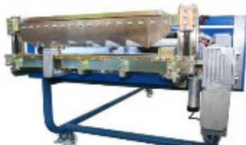
Detailaufnahme Quermessertrennung (K1-QMT) mit Elektromotor (K1-EQMT). Abb.: Abdeckhaube offen
