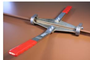
Abb. K8 Schließhebel komplett nach unten gedrückt
